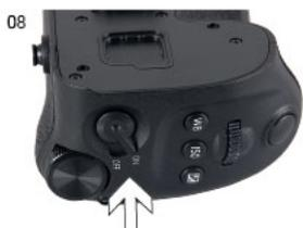
▲ Wenn Sie den Schalter des Hochformatgriffs auf <ON> stellen (Abb. 08), funktionieren die Tasten, Wählscheiben und der Auslöser des Batteriegriffs auf die gleiche Weise wie die Kamera. (Das Ein-/Ausschalten der Kamera ist mit dem Batteriegriff nicht möglich.)
