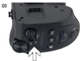
▲ Lorsque vous réglez le commutateur de poignée verticale sur <ON> (Fig. 08), les boutons de la poignée de batterie, les molettes et le bouton de déclenchement fonctionnent de la même manière que l'appareil photo. (Il n'est pas possible d'allumer/éteindre l'appareil photo avec la poignée de batterie.)
