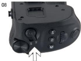
▲ Якщо встановити перемикач вертикальної ручки в положення <ON> (Мал. 08), кнопки ручки акумулятора, диски та кнопка вивільнення працюють так само, як і камера. (Увімкнути або вимкнути камеру неможливо за допомогою ручки для батареї.)
