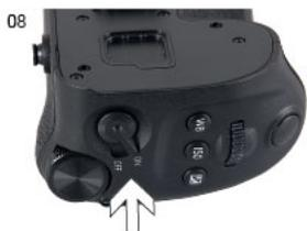
▲ Po ustawieniu przełącznika uchwytu pionowego w pozycji <ON> (rys. 08) przyciski uchwytu baterii, pokrętła i przycisk zwalniający działają tak samo jak aparat.
