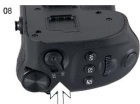
▲ Quando si imposta l'interruttore dell'impugnatura verticale su <ON> (Fig. 08), i pulsanti, le ghiera e il pulsante di rilascio dell'impugnatura della batteria funzionano allo stesso modo della fotocamera. (Non è possibile accendere/spegnere la fotocamera con l'impugnatura della batteria.)
