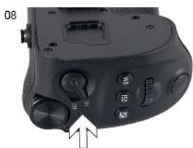
▲ När du ställer omkopplaren för vertikalt grepp på <ON> (Fig. 08), fungerar batterigreppsknapparna, rattarna och frigöringsknappen på samma sätt som kameran. (Det är inte möjligt att slå på/stänga av kameran med batterigreppet.)
